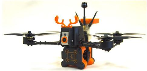
Abbildung 18. Integration in eine FPV-Drohne
